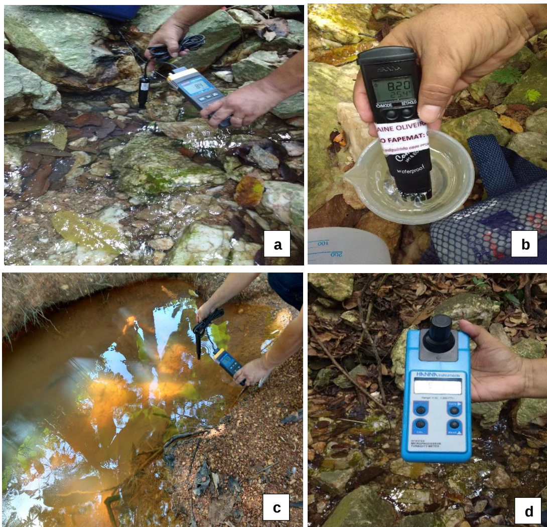
Figura 6. Análises instrumentais dos parâmetros físico-químicos da água (a) Avaliação por meio do oxímetro portátil: nascente Barbado; (b) Medidor Multiparâmetro; (c) Avaliação por meio do oxímetro portátil: nascente Gumitá; (d) Turbidímetro. Fonte: O Autor
