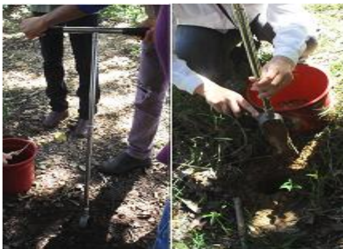
Figura 04. Coleta de amostras de solo com trado Holandês
