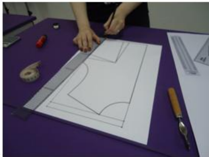
Figura 02 - Modelagem plana manual (Fonte: ESCOLA DE MODA, 2016)
