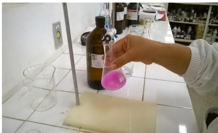
Figura 11 - Titulação da amostra com ácido clorídrico 5 M, para determinação da RBS.
