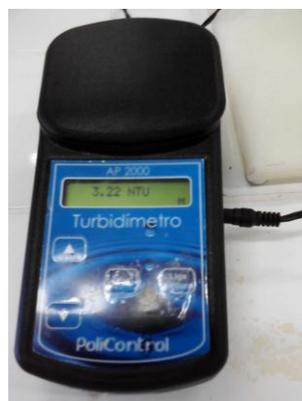
**Figura 3.** Aparelho de Turbidímetro marca POLICONTROL modelo AP 2000
