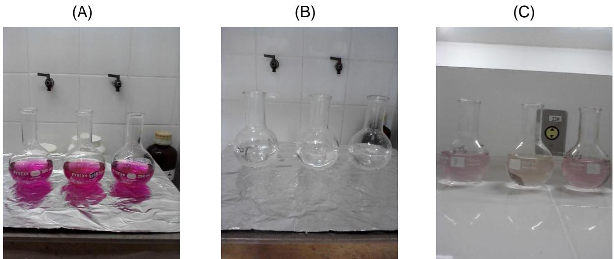
**Figura 8.** Amostras para determinação de oxigênio consumido: (A) Amostras para análise de oxigênio consumido; (B) amostras após adição de oxalato de amônio, (C) amostras após a titulação com  $\text{KMnO}_4$ .
