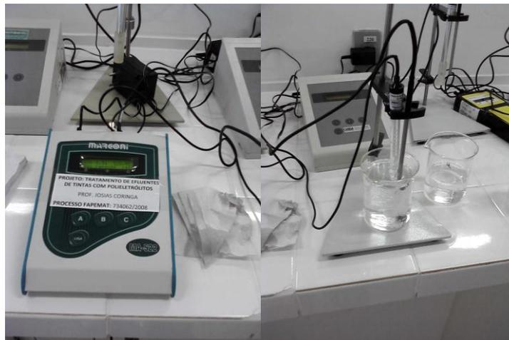
**Figura 2.** Medidor de pH marca MARCONI modelo MA-522/MA 522P
