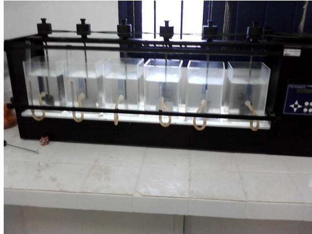
**Figura 9.** Aparelho Jar-test
