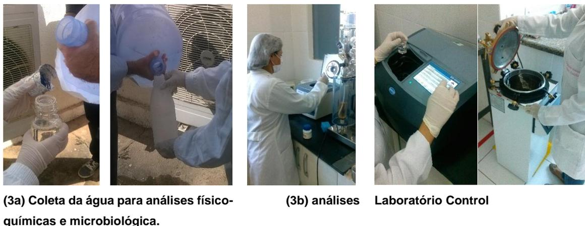
**Figura 3: Análises físico-químicas e microbiológica da água de drenagem dos aparelhos de ar condicionado. Laboratório Control.**
