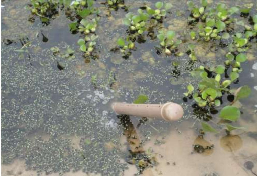
**Figura 4 - Coleta do sedimento com tubo de PVC.**
