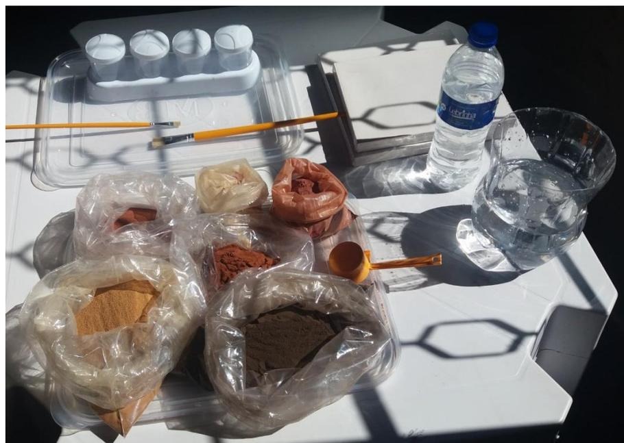
Figura 9: Solo destorroadado e peneirado e os materiais para confecção da tinta de solos
