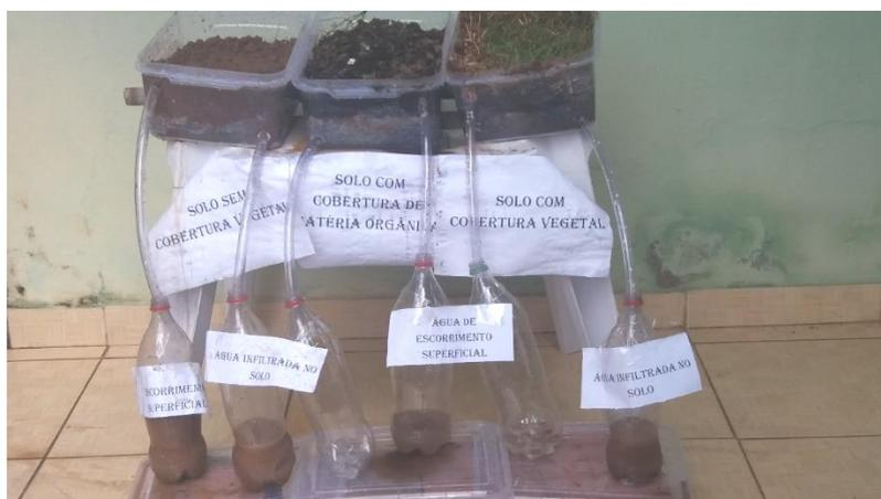
Figura 11: Infiltração e escoamento superficial
