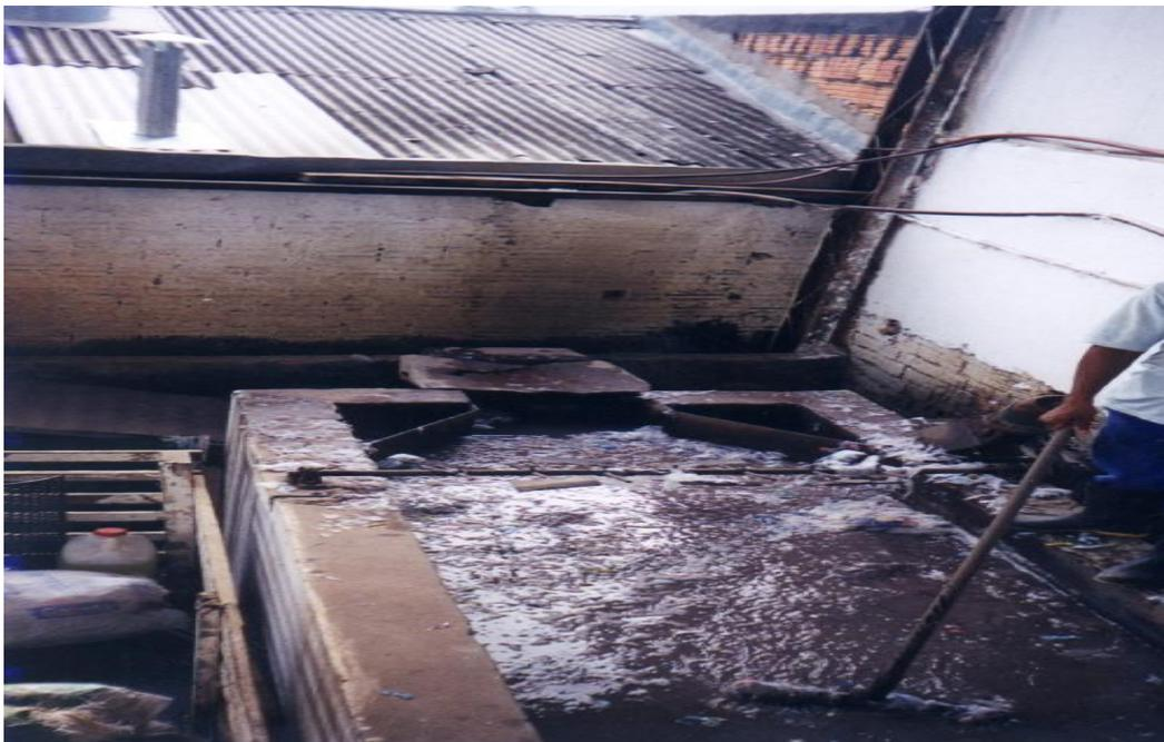
Figura 5: Processo de lavagem e separação (Tanque)
