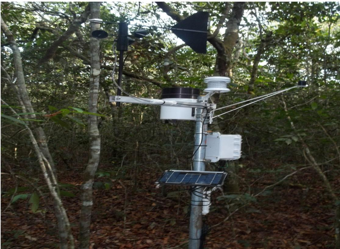
**Figura 12** – Estação micrometeorológica no fragmento de Cerradão em Campo Novo do Parecis, Mato Grosso. (ANGELINI, 2013)
