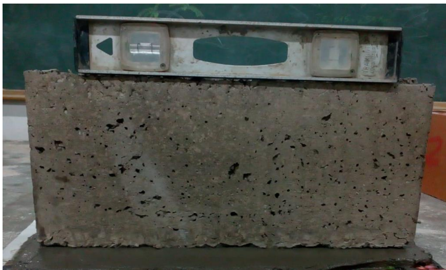
Figura 13: Bloco sendo capeado.
