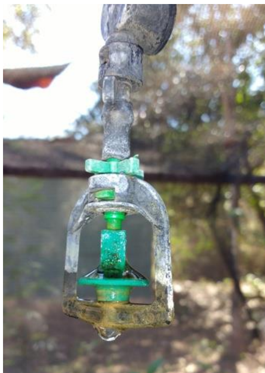
Figura 4. Aspersor de água usado no viveiro.
