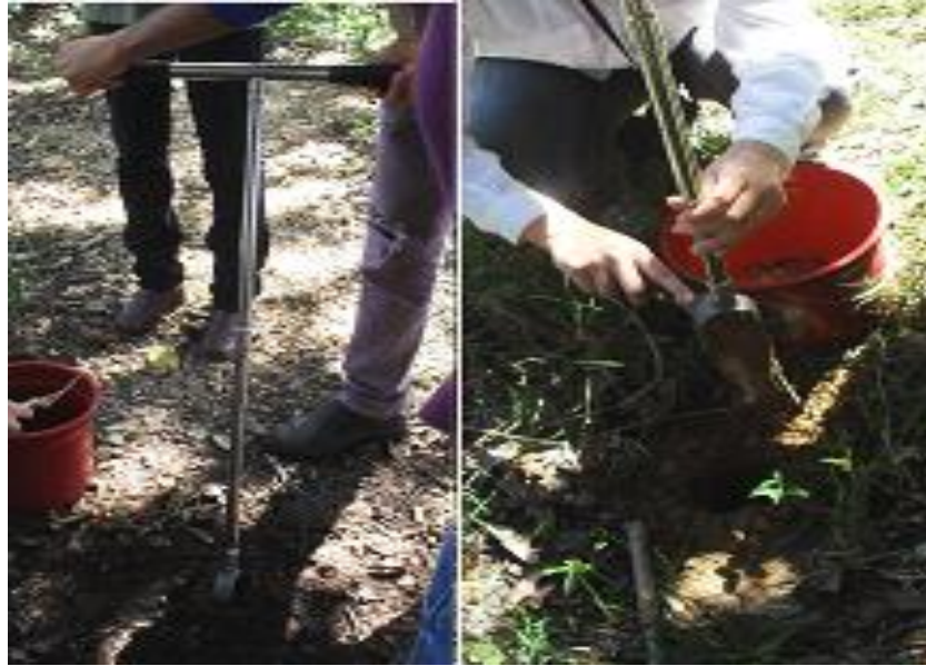
Figura 4: Trado Holandês utilizado para a coleta de amostras deformadas dos solos do Pantanal de Poconé.
