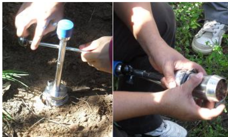
Figura 5: Amostrador de anéis utilizado para a coleta de amostras indeformadas dos solos do Pantanal de Poconé.
