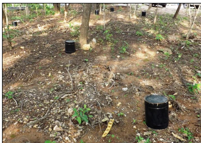
Figura 2. Campânulas (baldes plásticos) na área de coleta de efluxo de \text{CO}_2 do solo.
