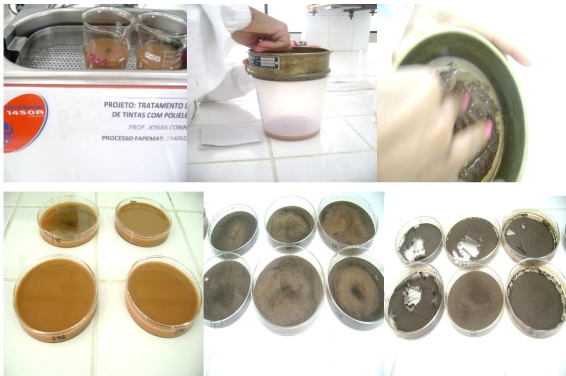
**Figura 5.** Fracionamento granulométrico e as frações obtidas antes e após a secagem.
