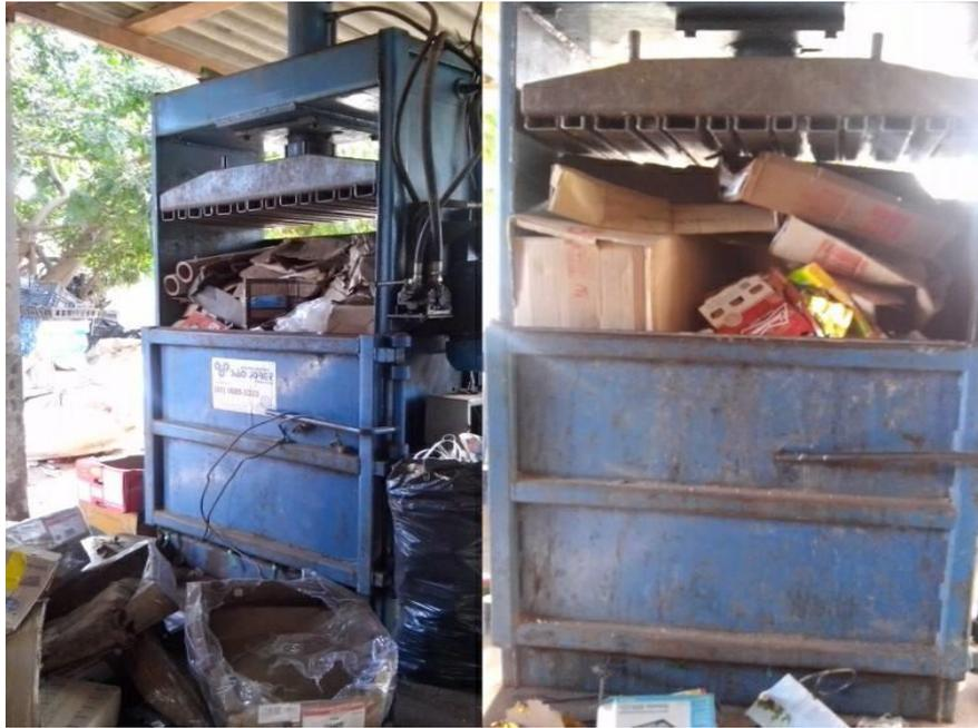
Figura 4 – Máquina de prensar as embalagens de RSU reciclado.
