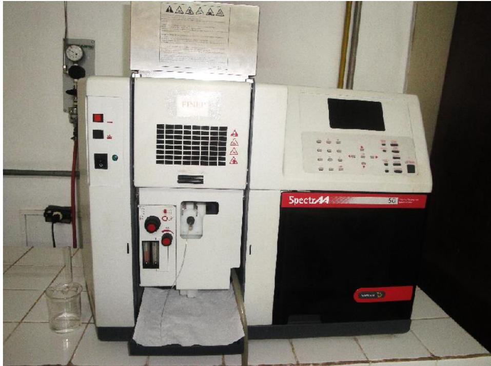
**Figura 9.** Espectrofotômetro de Absorção Atômica
