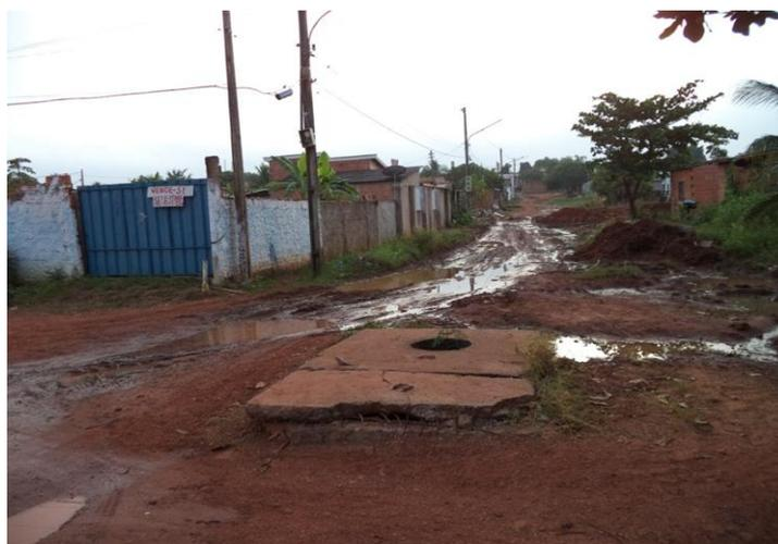
**Figura 11** - Vazamento da rede do DAE caindo em uma galeria de rede pluviais e indo para o córrego Jacaré no bairro Jardim Ipanema em Várzea Grande/MT.
