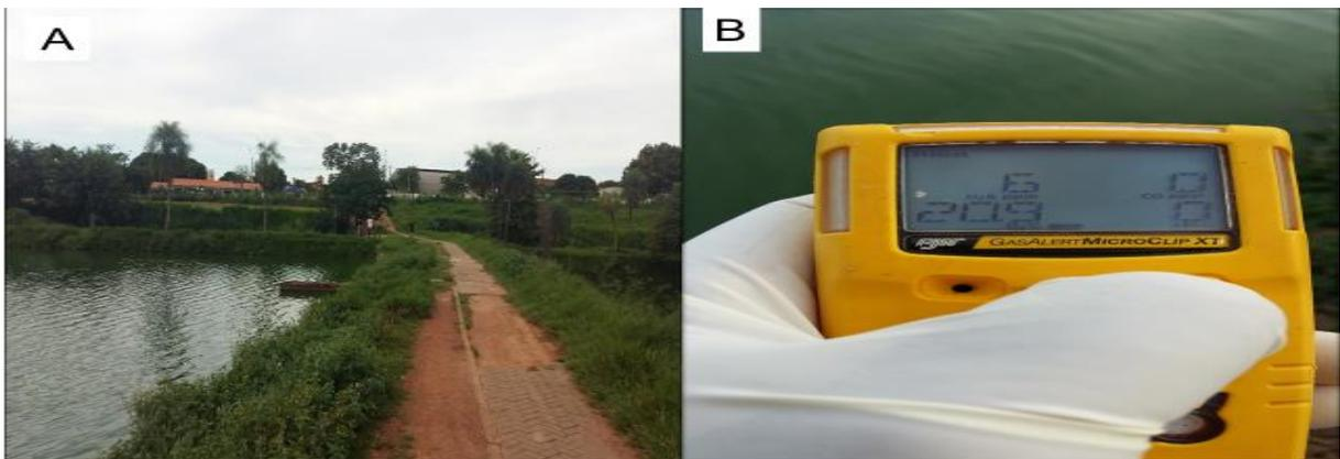
**Figura 3-** A) Ao fundo uma unidade de ensino e pessoas e realizando atividades físicas muito próximo da lagoa; B) Aparelho detectando 6 ppm de Sulfeto de Hidrogênio nas proximidades da lagoa.
