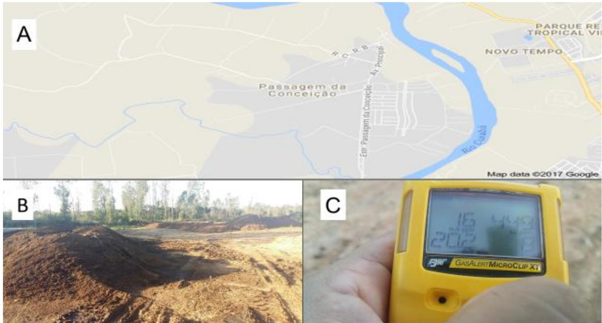
**Figura 12.** A) Localização do ponto de amostragem no Distrito de Passagem da Conceição em Várzea Grande – MT. Fonte: GOOGLE MAPS. B) Resíduos descartado próximo a indústria com forte odor. C) Medidor multigás aferindo os gases exalados pelos resíduos, valores muito elevados para H<sub>2</sub>S. e outros gases.
