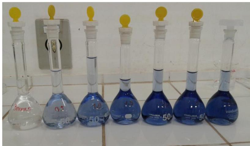
**Figura 4.** Padrões para construção da curva de calibração analítica
