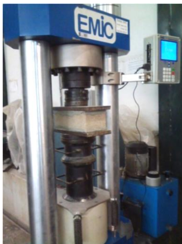
Figura 14 - Rompimento dos tijolos
