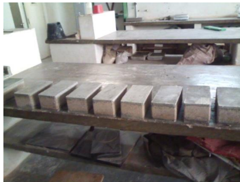
Figura 13 - Tijolos prontos para serem rompidos
