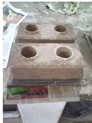
Figura 11 - Tijolos capeados 1 face
