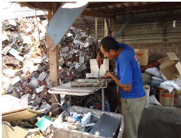
**Figura 12.** Extração dos componentes para venda. Fonte: PEREIRA, C.C.O., 2012
